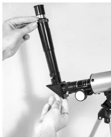
5. Для получения прямого изображения установите оборачивающую линзу или для увеличения кратности телескопа линзу Барлоу. Все зафиксируйте винтами
